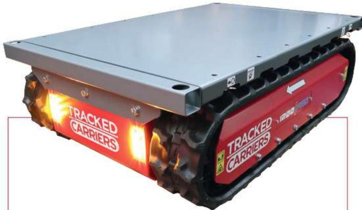
Le p'tit mulet 1200 est la machine à tout faire idéale. Avec une largeur de 750mm, les modèles 1200R et 1200PRO passent à travers la plupart des portes, et grâce à leur capacité de charge de 1200kg, ils sont des partenaires incontournables sur vos chantiers.
